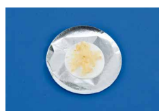
② アルミ箔の上ろ紙を1枚おきサンプルをろ紙に一定量採取
