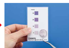
⑦ ろ紙に純水をかけ30秒後にカラーチャートと比較してPOV値を測定
