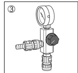
③ カプラー取付口(JS-3)に循環アスピレーターのワンタッチカプラーを接続してご使用ください。
