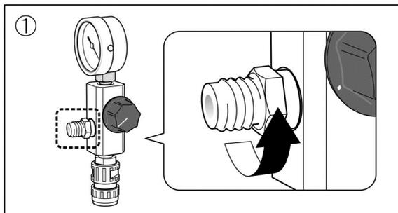
① 真空調節器の GL-14 吸引口取付部をスパナ(17mm)で取り外してください。
