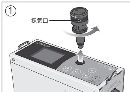
LD-5R本体から、採気口を(根元のローレット部を回して)取り外します。
