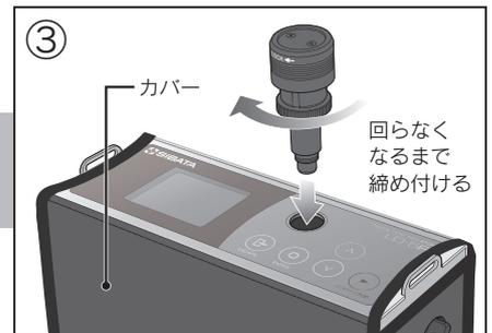
カバーをかぶせ、採気口をカバーの上からLD-5Rに取り付けます。
