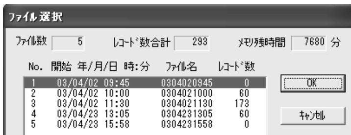
データファイル一覧の中から測定結果を表示するファイル名を選択し、[OK]ボタンをクリックするとデータ取得を開始します。データ取得中は以下のようにバーグラフを表示します。取得中に[中止]ボタンをクリックすると、取得を中止します。取得に要する時間は、動作時間が1時間で約40秒、24時間で約3分です。
