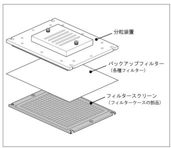
図のようにフィルターケースのフィルタースクリーンの 上にバックアップフィルターを置き、その上に分粒装置 を置きます。これをハイボリウムエアサンプラーに取り 付けて使用します。
