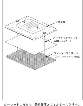
分粒装置に付属品のローレットつまみと E 形止め輪を取り付けることで、分粒装置とフィルタースクリーンを固定することができます。付属品のローレットつまみ、E 形止め輪の取り付けをおこなっていない状態でも通常通りご使用いただけます。
