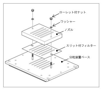
図のようにスリット付フィルターを分粒装置ベースと ノズルの間に挟みます。
