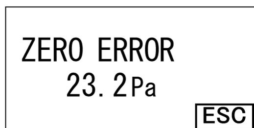
ESC キーを押してメイン画面に戻り、再度【START/STOP】スイッチを押してください。
