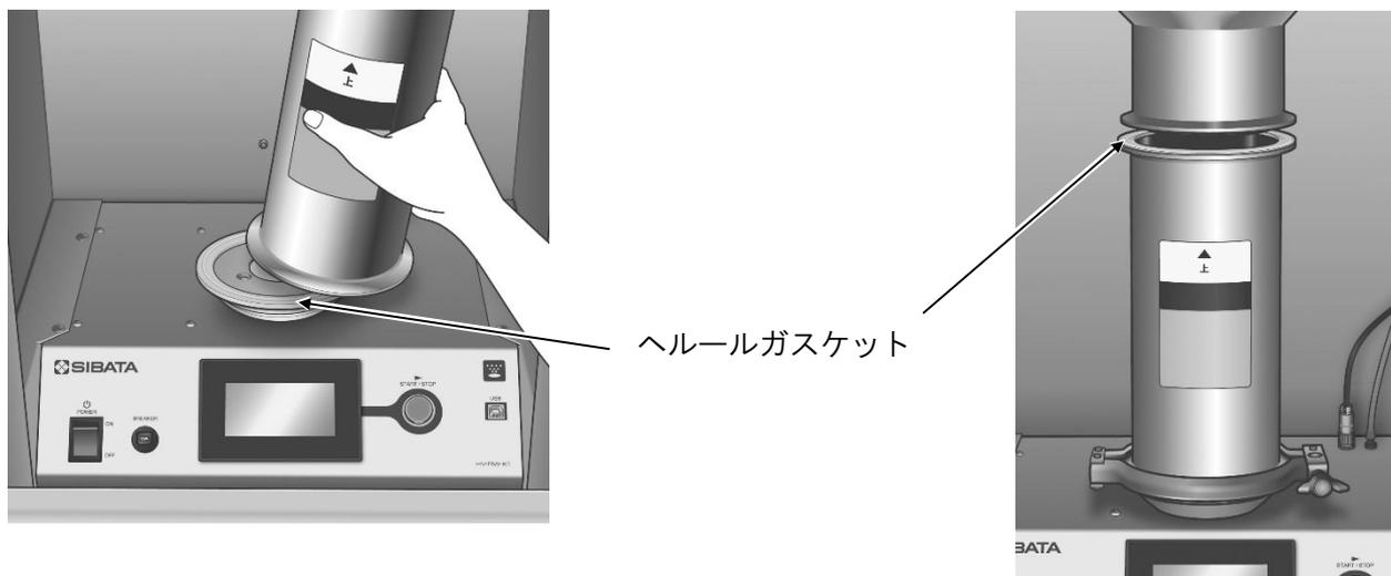
ホッパー固定用ネジを緩め、ホッパーを上段固定ブロックから外してシャトルチューブの上に置き、クランプで固定します。
