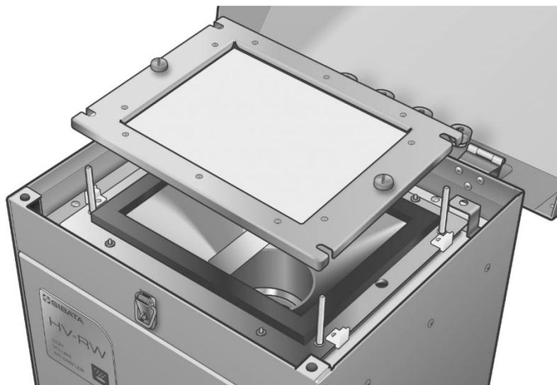
直立ボルトにワッシャーを置き、クイックランプノブを取付けて固定してください。
