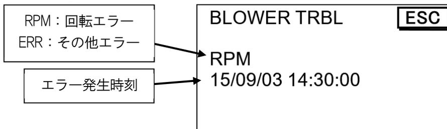
●内部温度が 95℃以上になると自動的にブロワーは停止します。その際エラー表示としては“RPM”と表示されます。
