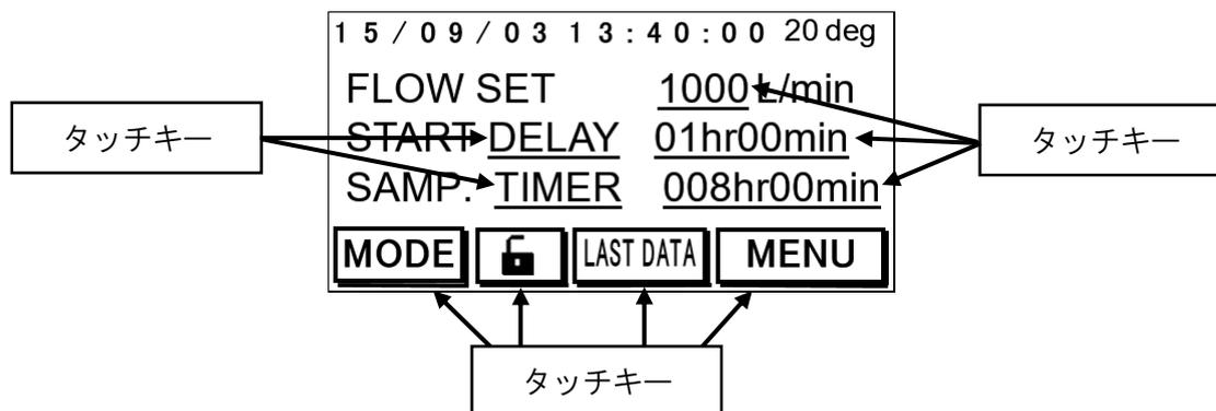
バックライト機能が付いています。1分間画面上の操作をしないとバックライトは消灯します。消灯中、画面に触れるとバックライトは点灯します。
