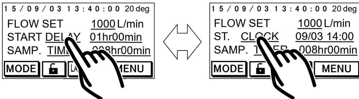
DELAY の横の数字を押すと、開始時間設定画面に進み、開始時間を設定することができます。
