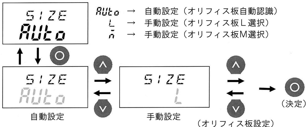
[ENTER] キーを押すことで表示が点滅し、[UP] [DOWN] キーで自動、手動を選択します。自動または手動 (オリフィス板LまたはM) を選択し [ENTER] キーで決定します。
