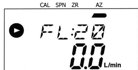
本製品は、センサを使用し流量を測定しているため、電源を入れてからセンサの出力が安定するまで時間を要します。電源 ON 後、10 分以上は暖機を行ってください。暖機を行わないと正しい流量が表示されないことがあります。
