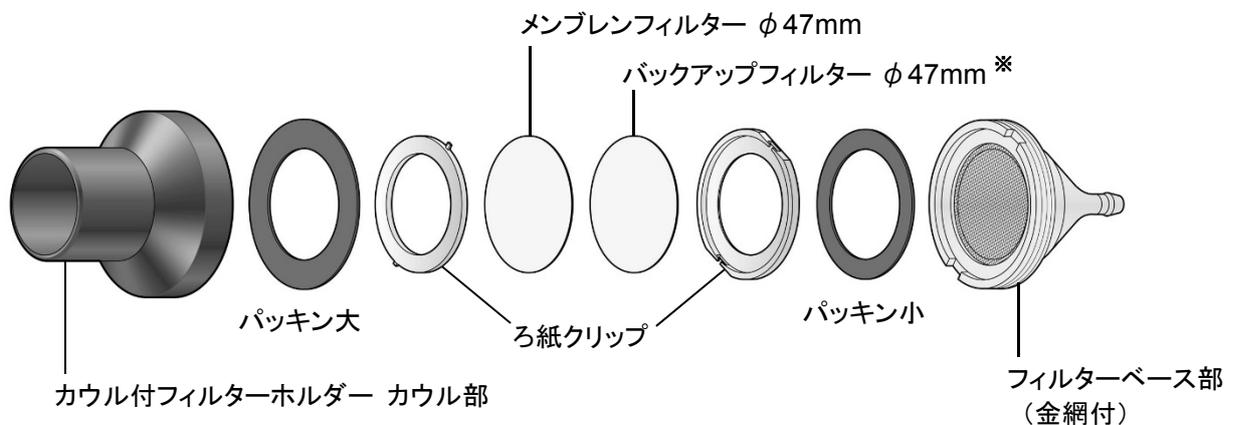
※ メンブレンフィルターの後ろ側にフィルターの破れ防止、吸引ポンプの汚染防止などのため、バックアップフィルター（PTFE バインダーフィルターまたはガラス繊維フィルター）を装着してください。
