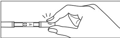
②PEキャップをはずし、カーボンピーズアクティブと吸引ポンプをお手持ちのシリコンチューブ等で接続します。個人曝露測定をする場合は、測定中に、ガラスのカット面を触れることがないように、必ず別売のガスチューブホルダーを使用してください。
