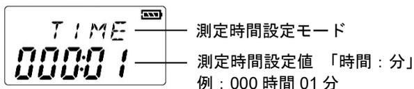
[START/STOP] を押すと、測定時間の「時間」部分が点滅し、設定変更が可能な状態になります。
