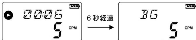
測定終了後、BG 測定値を表示するとともに本製品内部に設定されます。次回測定時よりこの値を自動的に減算します。
