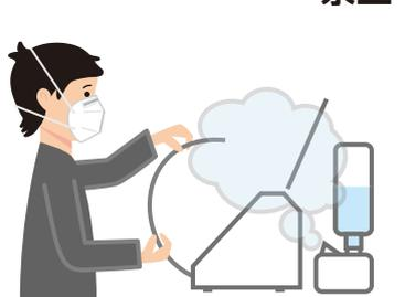
サンプリングチューブの先端をミスト放出ノズルに近づけない
