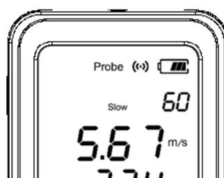
電池残量表示下部の計測秒数が表示されます。
