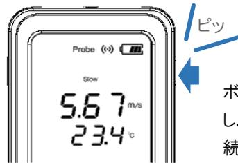
ボタン操作時にバックライトが点灯し、操作しない状態が5秒以上続くと自動的に消灯します。
