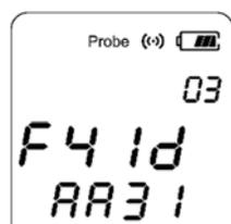
「Probe」が点灯し、認識できたプローブ本数と認識番号が表示されます。
