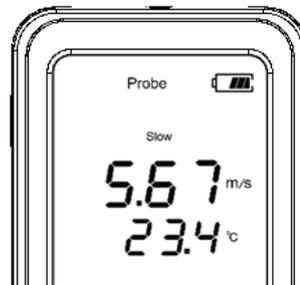
接続後計測値が表示され、計測モードに移行します。
