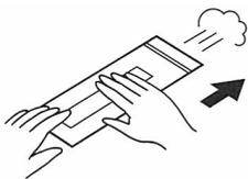
試験紙の入ったパックを平らな場所に置き、指の腹でパックの上から軽く押さえるようにして、中の空気を抜き、パックと試験紙を密着させてチャックを閉じます。
