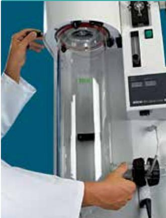
工具が不要で無理なく簡単に行うことができます。乾燥シリンダーの装着はロッキングレバーを操作するだけで完了です。
