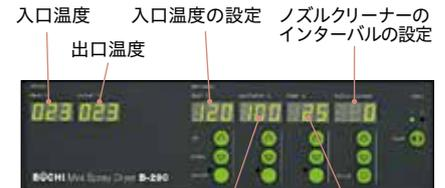
コントロールパネルでは運転中の温度確認と各項目の設定が簡単にできます。ノズルの目詰まりを防ぐために、ノズルクリーニングを自動間隔で作動させることができます(手動操作も可能)。
