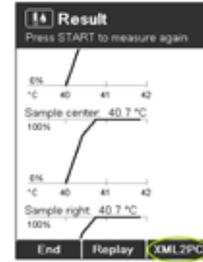
XML2PCボタンを押すと、測定結果をLIMS端末用PC等にXML形式で転送できます。転送にはプリンター出力用のシリアルポートが使用されます。
