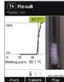
動画による測定の見直しが可能。1フレーム毎のコマ送りから100倍速までの速度可変再生が可能。
