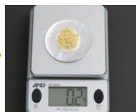
② アルミ箔の上にも紙を1枚置きサンプルをろ紙に採取・計量
