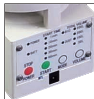
② 空気量と待機時間を選択し、培地をセットしてサンプリングを行う
