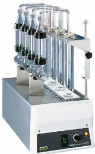
品名 酸分解(加水分解)装置 B-411 100V 品番 37456
