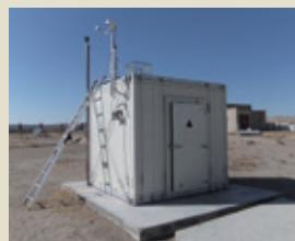
近年、春先の2月から5月にかけて、黄砂の飛来観測が報道をにぎわしています。従来、黄砂の観測は地上での目視観測に限られ、モヤなのか黄砂なのか判別も困難でした。このため新たにライダー装置が開発され、高度分布のリアルタイムな観測が可能となりました。
