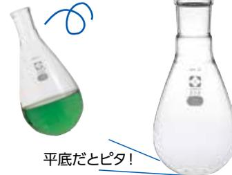
平底なす形フラスコは「容量別」「ジョイント規格別」で、合計36種類。
