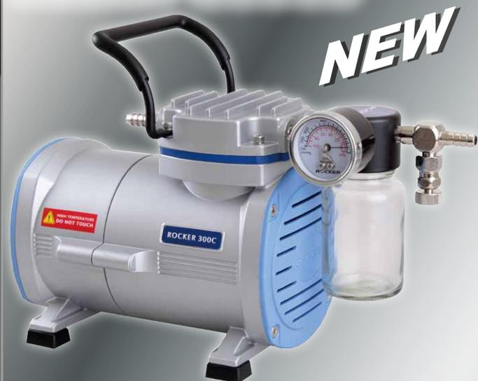
Rocker 300型の耐溶媒仕様です。ポンプヘッド内およびダイヤフラムはPTFEコートされており、強酸、強アルカリを除く腐食性ガスに耐性があります。蒸留や濃縮、溶媒を使つての減圧ろ過など、幅広い用途にご使用いただけます。真空レギュレーターとトラップびんが標準で付属しています。
