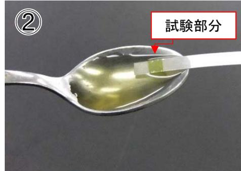
② 試験部分に油を浸し、ふちで余分な油を軽くふき取る。
