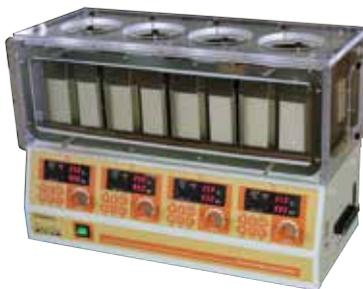
合成・反応装置ケミストプラザ CPG-2000型(サンプル容量~200mL×4検体)にて、標準仕様で-30~200℃までの温度設定範囲を、加熱ブロック部等の特注対応により、室温+10~350℃に変更することが可能です。高温でのスクリーニングをご検討のお客様は、是非ご相談ください。
