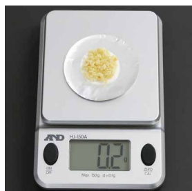
② アルミ箔の上にもろ紙を1枚置き サンプルをろ紙に採取・計量
