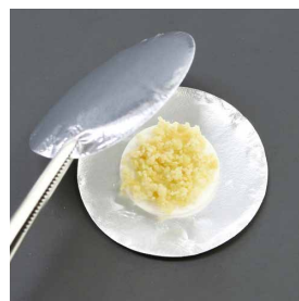
③ アルミ箔を更に1枚重ねてから 指でサンプルを上から押す
