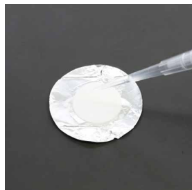
⑤ アルミ箔1枚とサンプルを取り 除き、ろ紙に液体試薬を添加
