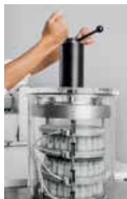
乾燥プロセスからバイアル閉栓作業への流れ(イメージ)
