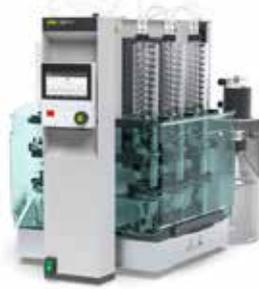
蒸気加熱式抽出装置
